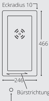
15 mm  $\varnothing$  Bohrung für Abлаuffernbedienung
